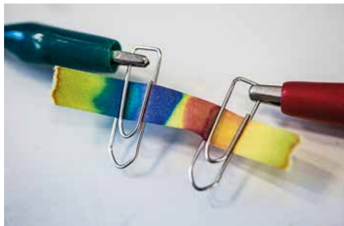
Figur 10: Under elektrolysen splittes vand til \text{OH}^- og \text{H}^+ , som farver universalindikatorpapiret.
