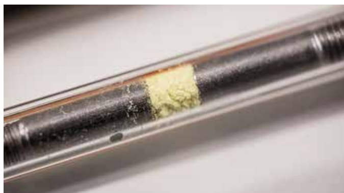
Figur 3: Et par millimeter af pulveret er placeret mellem de to elektroder.
