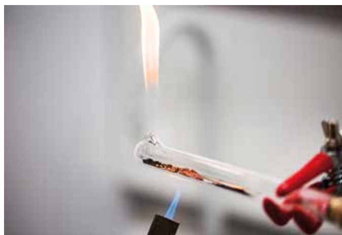
Figur 18: Under reduktionen omdannes det sorte pulver af kobberoxid til det rene, kobberfarvede metal.
