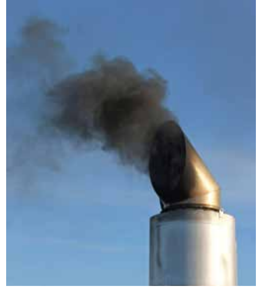
Figur 3b: Uden katalysator ville især dieselmotorer forurene voldsomt med sod og skadelige partikler. Ce_xZr_{1-x}O_2 bidrager til at forbrænde denne forurening til CO_2 og H_2O . Ce_xZr_{1-x}O_2 nanopartikler er særligt effektive på grund af deres store overfladeareal. (Foto: Colourbox)
