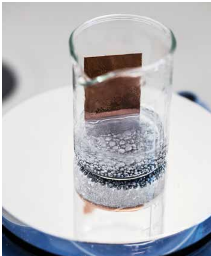
Figur 31: En kobberplade placeret i den basiske opløsning med metallisk zink og zink-ioner.
