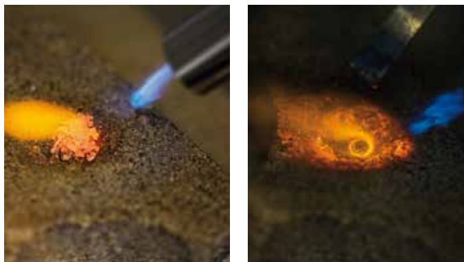
Figur 36: Sølvet placeres i en udhulning i en vermiculitplade og smeltes med en gasbrænder. Borax er med til at få det smeltede sølv til at samle sig i en dråbe.
