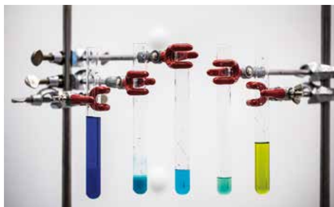
Figur 26: Fra venstre ses en opløsning med kobber(II) kompleksbundet til \text{NH}_3 (mørkeblå), udfældet som lyseblåt kobberhydroxid, kompleksbundet til vand (midten), til både vand og klorid (lysegrøn) og til klorid (gul).
