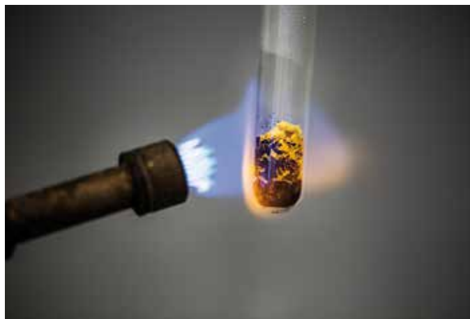
Figur 20: Ved opvarmning oxideres oxalat-ionen, og der dannes rent jern.
