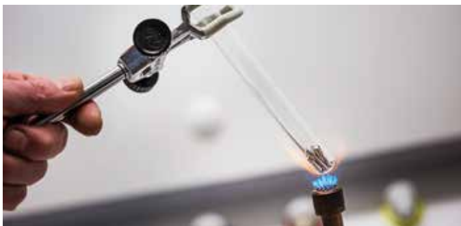
Figur 27: Aluminium opvarmes over en bunsenbrænder, til det smelter.
