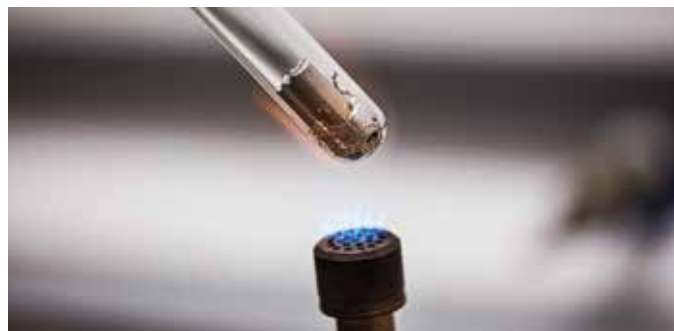
Figur 28: Når alt aluminium er smeltet, tilføjes magnesiumklumpen.
