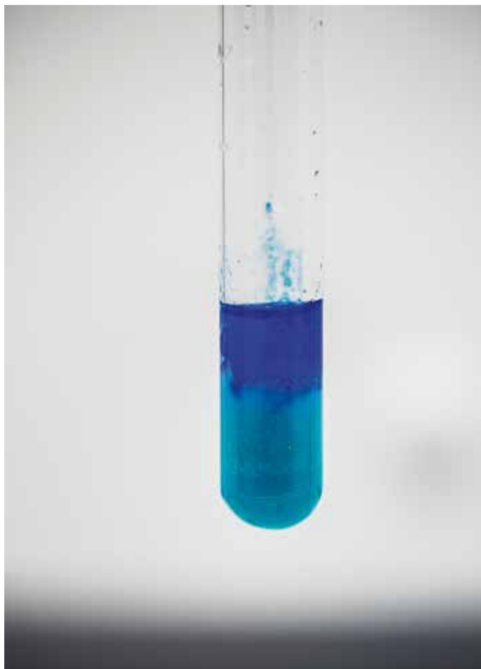
Figur 24: I en opløsning med kobber(II)ioner og ammoniak udfældes lyseblåt kobberhydroxid. Når mere ammoniakvand tilsættes, opløses det igen, og det mørkeblå kobber(II)tetra-amin kompleks dannes.
