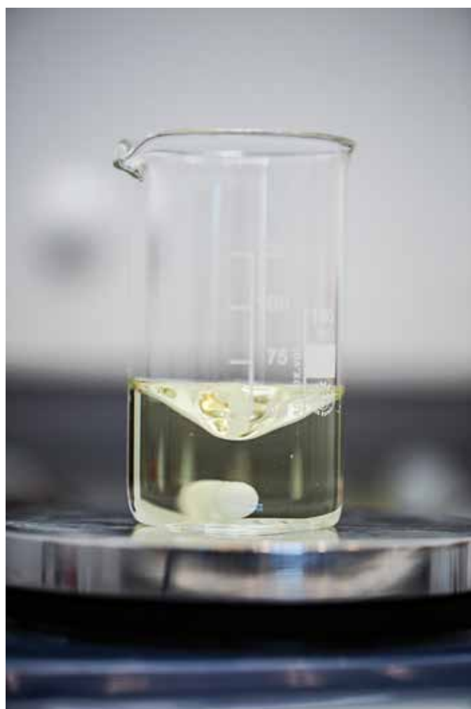
Figur 13: Allerede efter få milliliter ammoniakvand vil de udfældede partikler opløses, og opløsningen bliver gullig eller grønlig.
