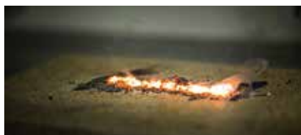
Figur 6: Resultatet af afbrændingen er en blanding af kobber og zinkoxid
