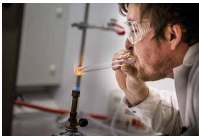
Figur 16: Reduktionsrøret laves ved glasblæsning
