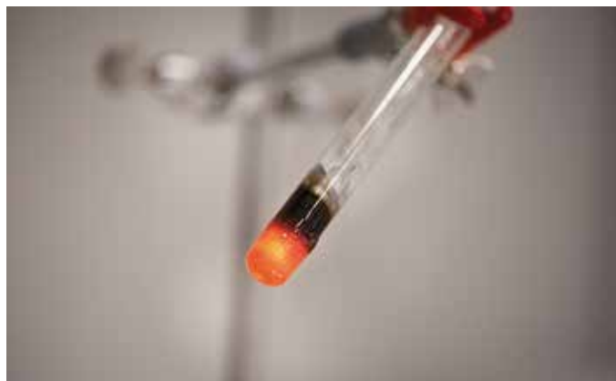
Figur 14: Blandingen af sand og magnesium opvarmes i et reagensglas, til det har været rødglødende. Opvarmningen får glasset til at deformere.
