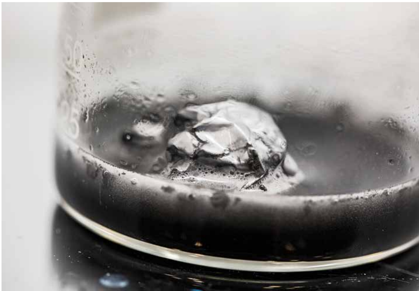
Figur 41: Aluminium-folie opløses i KOH-opløsningen.
