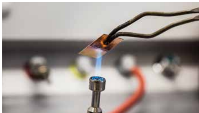
Figur 32: Den zink-belagte kobberplade varmes i flammen af en bunsenbrænder, hvorved messinglegeringen dannes.
