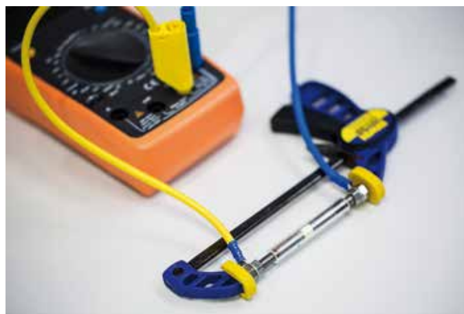
Figur 1: Opstilling til ledningsevne-måling af pulvere.
