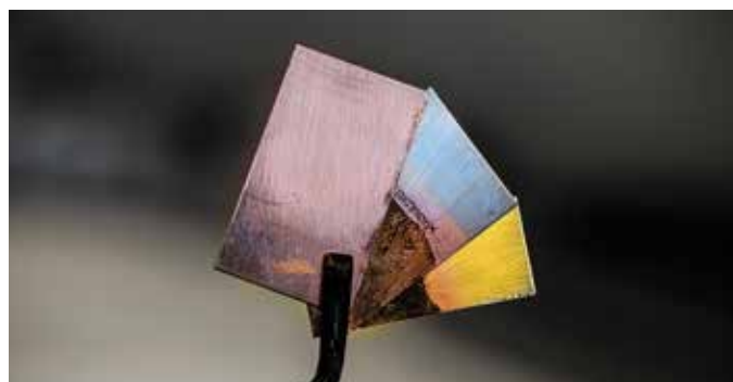
Figur 33: Det færdige resultat: En ren kobberplade, en sølvfarvet zink-belagt kobberplade og en gylden messinglegering.
