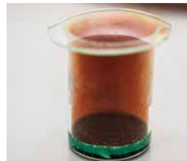
Figur 7: Når kobber reagerer med HNO 3 i en koncentreret opløsning, dannes den brune NO 2 -gas. I opløsningen kompleksbindes kobber(II)ioner til vand eller nitrat, hvilket giver hhv. en blå og en grøn farve. Opløsningen fremstår derfor blågrøn.
