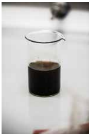
Figur 38: Efterhånden som ammoniak-opløsningen blandes i opløsningen med jern(III)- og jern(II)klorid dannes den sorte magnetit. Når der er tilsat nok ammoniak, fremstår opløsningen sort som blæk.
