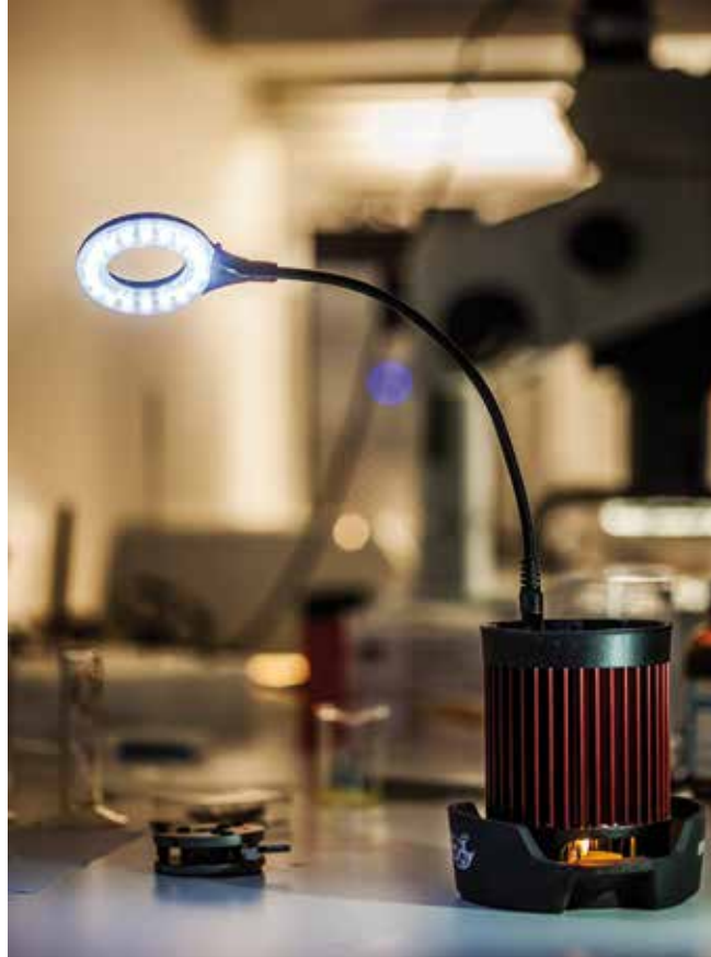
Figur 1a: En demonstrationsmodel af et termoelektrisk modul. Fyrfadslyset nederst opvarmer den ene side af modulet (indkapslet i den røde kappe), hvilket får lampen til at lyse. Ideelt set udnytter man spildvarme, f.eks. fra konventionel el-produktion, for at opnå en høj energieffektivitet.
