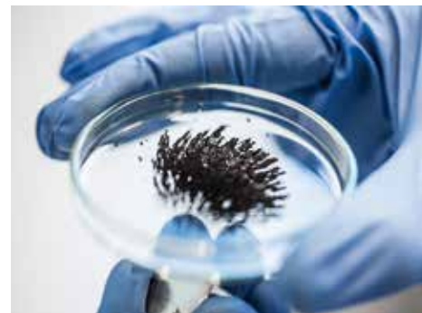
Figur 40: De magnetiske egenskaber af den tørre magnetit demonstreres med en kraftig magnet.
