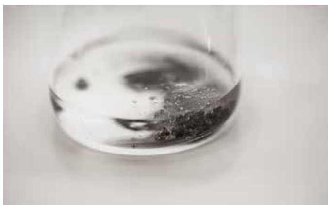
Figur 15: Silicium oprenses ved at lade magnesiumoxid og magnesiumsilicid reagere med saltsyre i et bægerglas.
