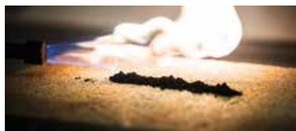
Figur 5: En "pølse" af en blanding af zink og kobberoxid antændes ved enden med en gasbrænder.
