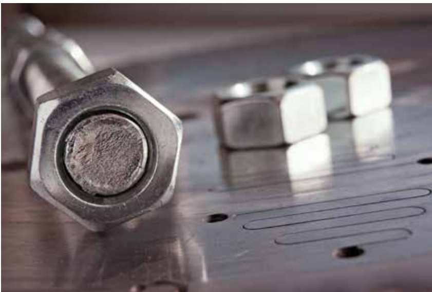
Figur 2b + c: Nikkel bruges også i rustfristål for at gøre legeringerne modstandsdygtige overfor korrosion. Derudover er nikkel også med til at give legeringer styrke, og det bliver derfor brugt i bl.a. skruer og møtrikker, eller sågar panser til kampvogne. (Fotos: Colourbox)
