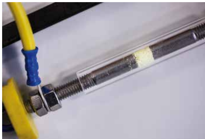
Figur 2: Kabelsko er spændt fast mellem to møtrikker.
