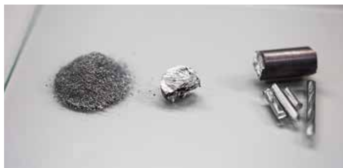
Figur 30: Pulveriseret magnalium (venstre), en klump af den dannede magnalium (midten) og udgangsmetallerne, aluminium og magnesium (højre).
