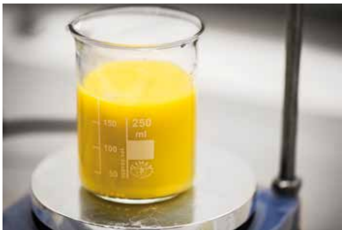
Figur 19: Efter kort tids magnetrøring udfældes den gule jernoxalat.
