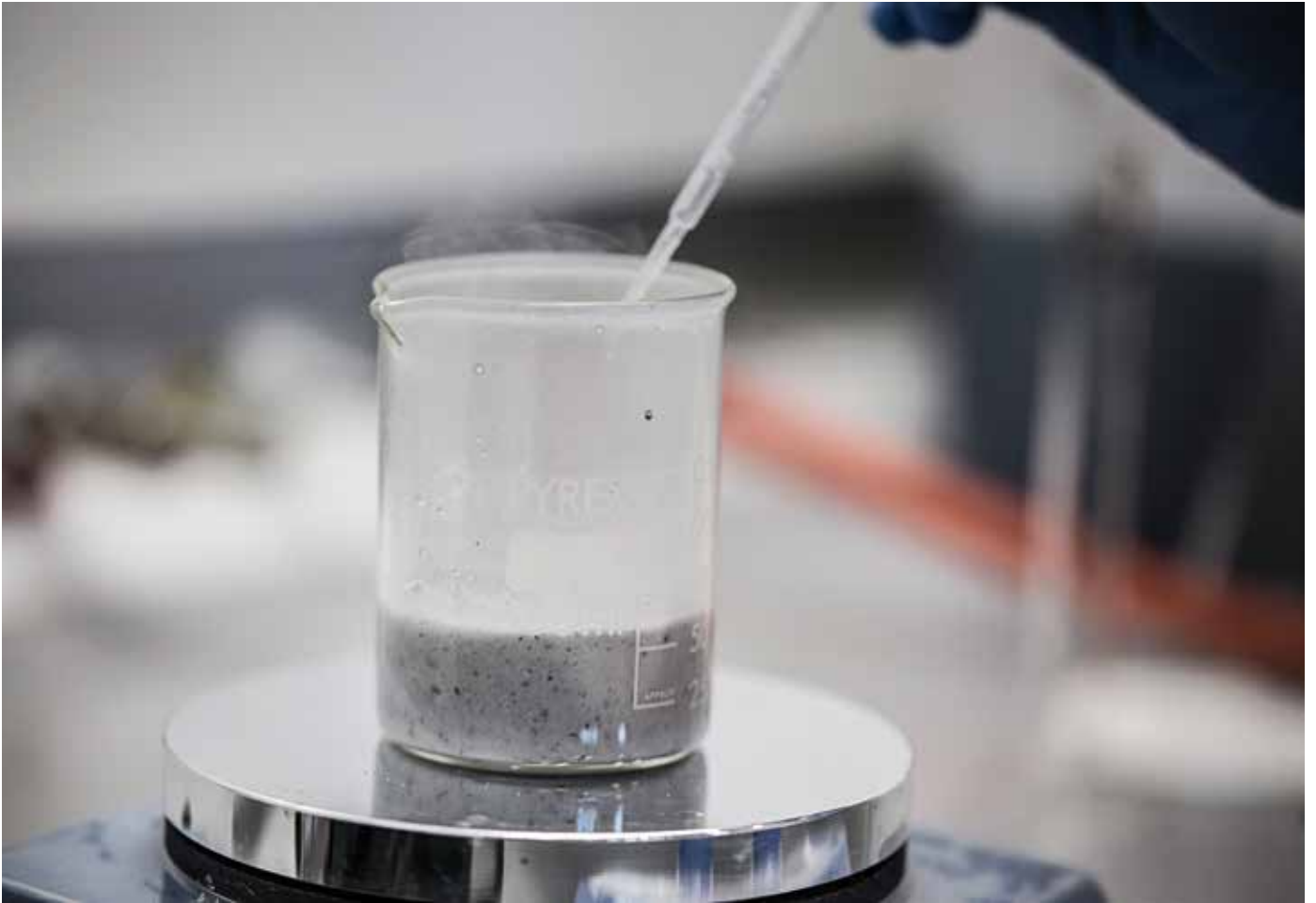
Figur 42: Koncentreret svovlsyre tilsættes langsomt med en pipette under magnetomrøring. Under reaktionen mellem vandet og syren udvikles der så meget varme, at noget af vandet fordamper.
