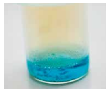
Figur 8: Når kobber reagerer med HNO 3 i en 4 M opløsning, dannes der hovedsageligt NO- men også NO 2 -gas. I opløsningen kompleksbindes kobber(II)ioner til vand, hvilket gør opløsningen blå.
