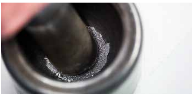
Figur 29: Den sprøde magnalium knuses let i en morter.
