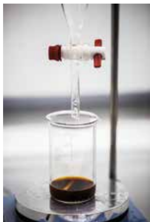
Figur 38: Efterhånden som ammoniak-opløsningen blandes i opløsningen med jern(III)- og jern(II)klorid dannes den sorte magnetit. Når der er tilsat nok ammoniak, fremstår opløsningen sort som blæk.
