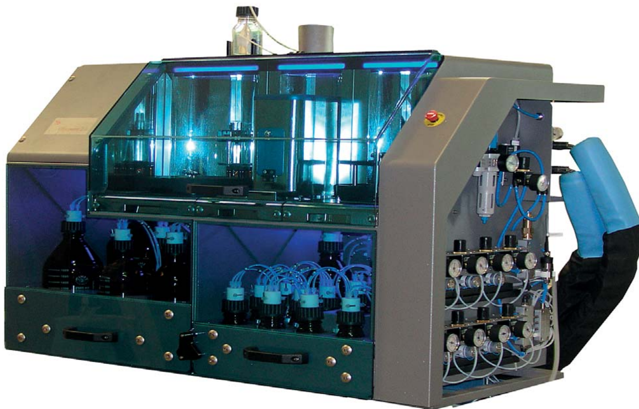
Syntesemaskiner til at lave oligosakkarider er så småt ved at blive kommercielt tilgængelige. Billedet viser The glyconeer fra det tyske firma GlycoUniverse GmbH.
