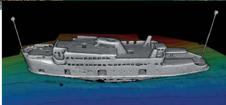
Sensory scan af vraget på bunden af Det Sydfynske Øhav foretaget med multibeam ekkolod. Kilde: SensorSurvey .
