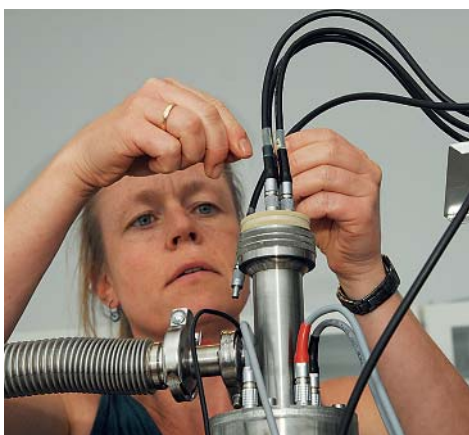
Tina Hecksher i laboratoriet. RUC-forskerne har målt på silikoneolien i det lave frekvensområde fra 1 millihertz til omkring 1 MHz, mens MIT-forskerne har målt fra 1 MHz op til 1 THz.
