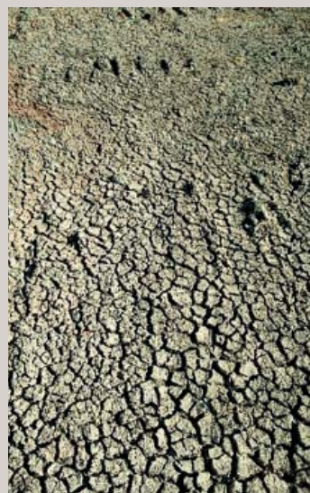
Blottet overflade af plastisk ler. Bemærk volumenreduktionen, når leret tørrer ud, og de medfølgende store sprækker. Foto: Thomas Rye Simonsen
