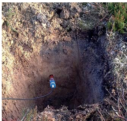
Med en ny, robust pH-måler, kan forskere nu måle jordens pH direkte i felten. Foto: Knud Erik Nielsen, AU.
