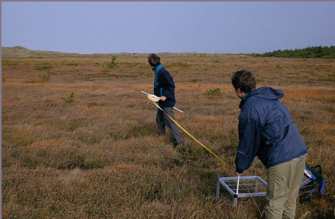
Prøvetagning i NOVANA. Det grå stativ forrest i billedet er en "pin-point ramme". Foto: Knud-Erik Nielsen.
