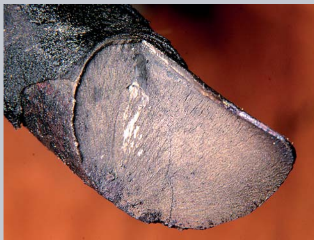
Nærbillede af et brud forårsaget af metaltræthed i en fjeder fra en bil. Der ses også flere mindre revner, som også er begyndende træthedsbrud.
