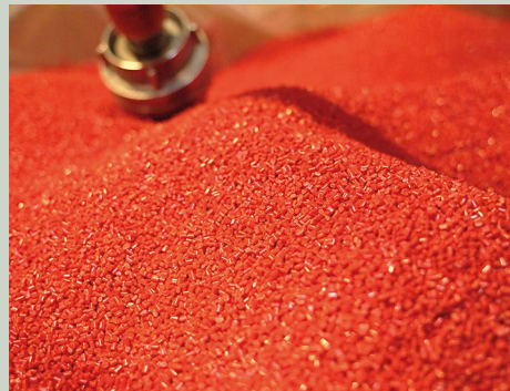
Granulat af ABS-plast er råmaterialet til de fleste af LEGO's elementer. Foto: LEGO.
