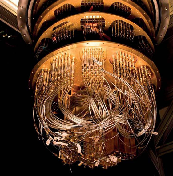
Googles state-of-the-art kvanteprocessor, kaldet Sycamore, indeholder 53 kvantebits. I drift befinder chippen sig i en såkaldt cryostat (billedet til tv), der holder chippen nedkølet. Fotos: Erik Lucero/Google.
