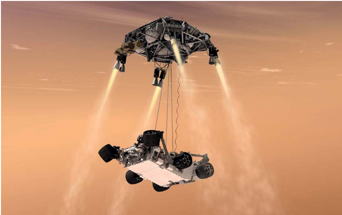
Illustration af den manøvre kaldet "sky crane", som bragte Marsroveren Curiosity sikkert ned på planeten i 2012. Den samme metode skal bruges til Perseverance, der når frem til Mars i februar 2021. Illustration: NASA/JPL-Caltech.
