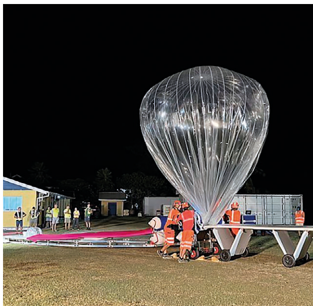
Forskere i færd med at opsende en ballon udstyret med sensorer, der er i stand til at registrere jordskælv tusinder af kilometer væk.
