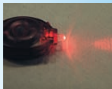
En moderne diode-cykellygte. Læg mærke til, at lyset er rødt, selv om lysdioden er af farveløs plast.
