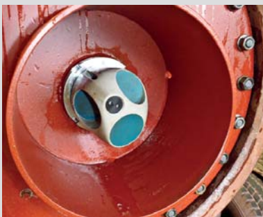
Den ultrasoniske strømsensor – dvs. selve måledelen, som er placeret under bunden af lystønden.
