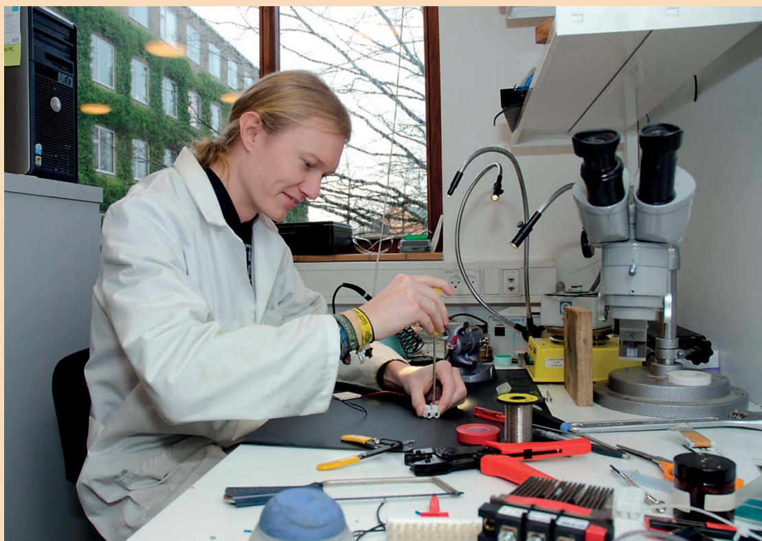
Ph.d.-studerende Kasper Borup i CMC's analyselaboratorium for fysiske materiale-egenskaber, i færd med at montere kredsløb på et kommercielt termogenerator-modul.
