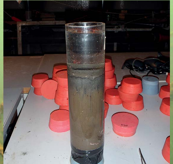
Prøverne blev holdt under konstante forhold i laboratoriet (mørke, 15°C). I løbet af forsøgets varighed blev nedbrydningen af organisk stof fulgt med høj tidslig opløselighed.
